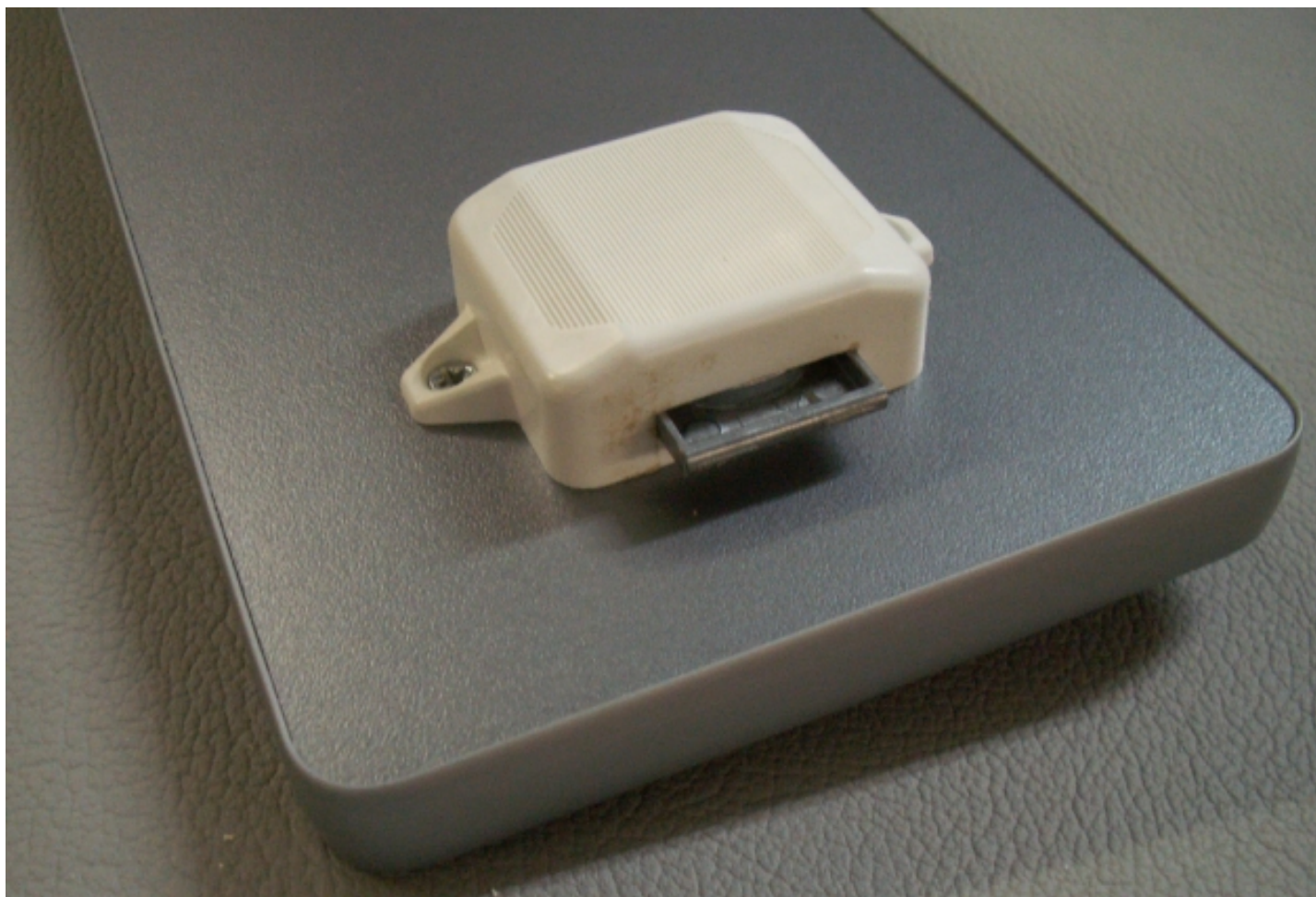
Frontklappen-Rückseite mit aufgeschraubtem Drucktastenschloss (Spax 3,5x15)
